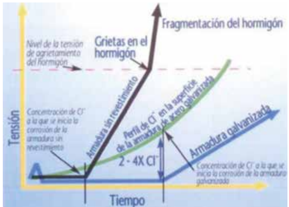
Gráfica.1 Vida útil en servicio: acero en negro VS acero GIC. [10]
